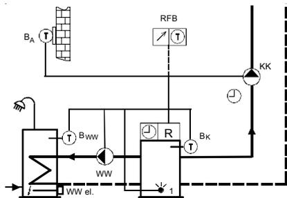
**- Circuito con valvola miscelatrice (con controllo della temperatura di ritorno)**
