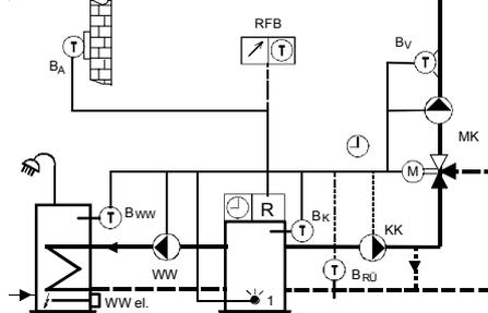
**- Circuito con valvola miscelatrice e circuito di riscaldamento diretto.**
